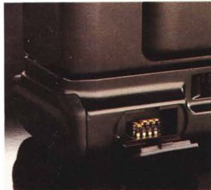
L'Extension Unit mette a disposizione una porta SCSI e consente riprese in rapida sequenza, a 4.5 fotogrammi al secondo (vedi testo).
